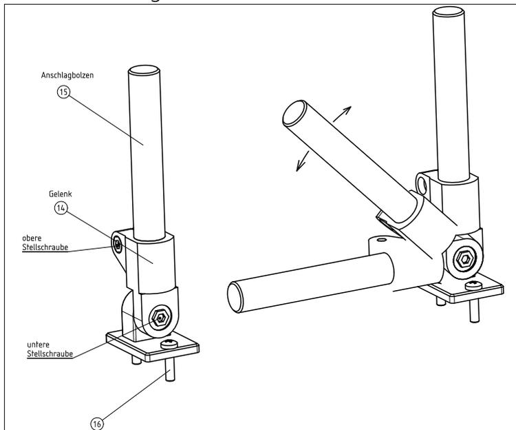
Die Baugruppe (Gelenk 14 + Anschlagbolzen 15) ist vormontiert und kann in der Schublade nach Wahl mittels der beiden Schrauben (16) in der Schublade verschraubt werden.
