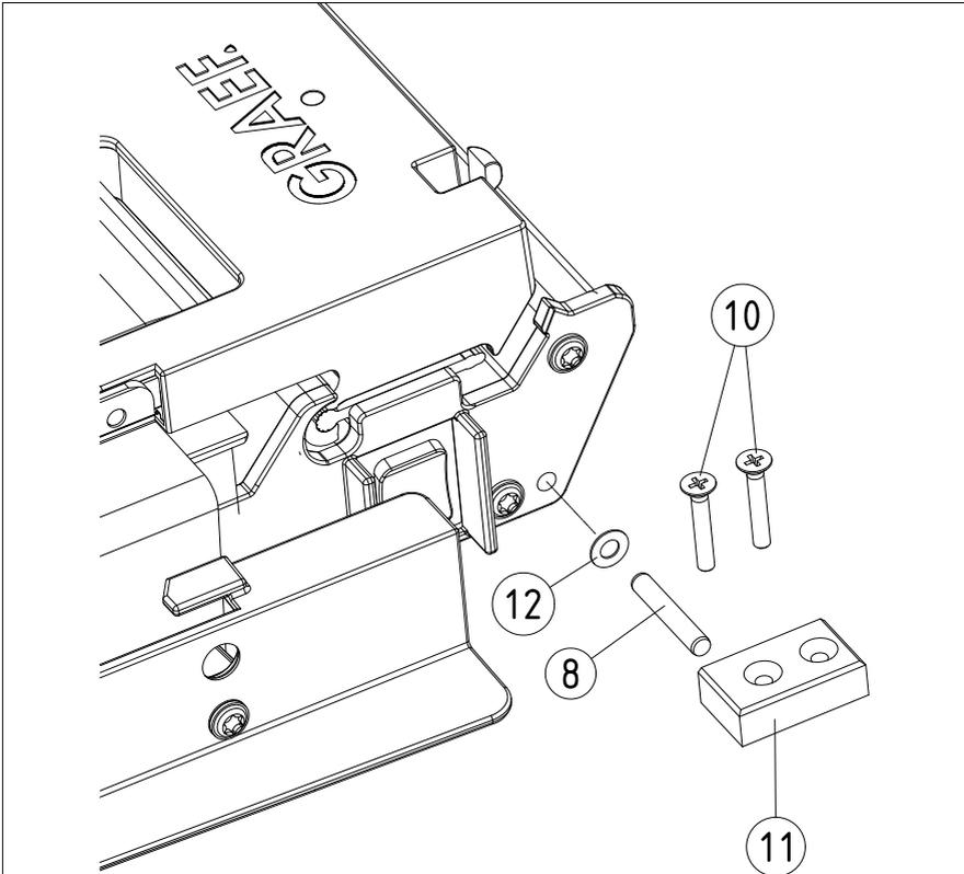
2.5 Jetzt kann die Maschine mittels der beiden Schrauben Pos.10 in der Schublade befestigt werden.
