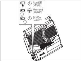
Drücken Sie die gewünschte Schalterposition „Dauerbetrieb“ oder „Kurzzeitbetrieb“.
