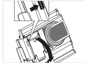
Drücken Sie den Schieber seitlich des Schlittens und klappen diesen runter.
