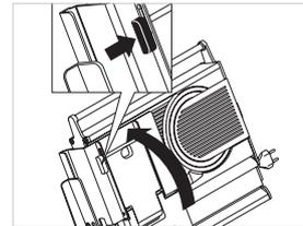
Drücken Sie den Schieber seitlich des Schlittens und klappen diesen nach oben.
