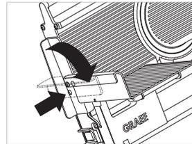
Nach Beendigung des Schneidvorgangs stellen Sie die Schnittstärke auf 0 und stellen Sie den Daumenschutz wieder in die waagrechte Position.
